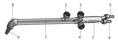
Расположение смесительного узла в мундштуке существенно повышает безопасность резака при возникновении внутреннего горения (обратного удара). Трубки, изготовленные из нержавеющей стали. Конструкция резака позволяет производить замену газосмесительных мундштуков непосредственно на рабочем месте.
